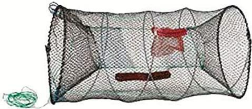
Figura A2.1 Nassa ad inganno caratterizzata da due ingressi ad imbuto, chiusura a molla, tasca porta-esca, cerniera per la fuoriuscita degli organismi, filo di nylon per attacco. Dimensioni da aperta = 30x60 cm, dimensioni da chiusa: 30x2,5 cm, diametro: 14,5 cm, dimensioni maglie: 1x1 cm..
