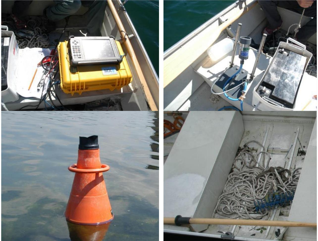
*Figura 2.1. Attrezzatura utilizzata per i transetti: ecoscandaglio con computer portatile da campo resistente all'acqua (in alto a sinistra); telecamera subacquea (in alto a destra); batiscopio (in basso a sinistra); rastrello (in basso a destra).*
