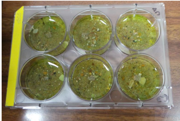
Figura 10.1. Piastre di polistirene allestite con sedimento, sospensione algale e acqua standard per il test con H. incongruens
