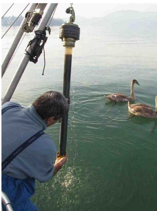
Fig. 5.1. Prelievo di sedimento lacustre mediante carotatore a gravità.
